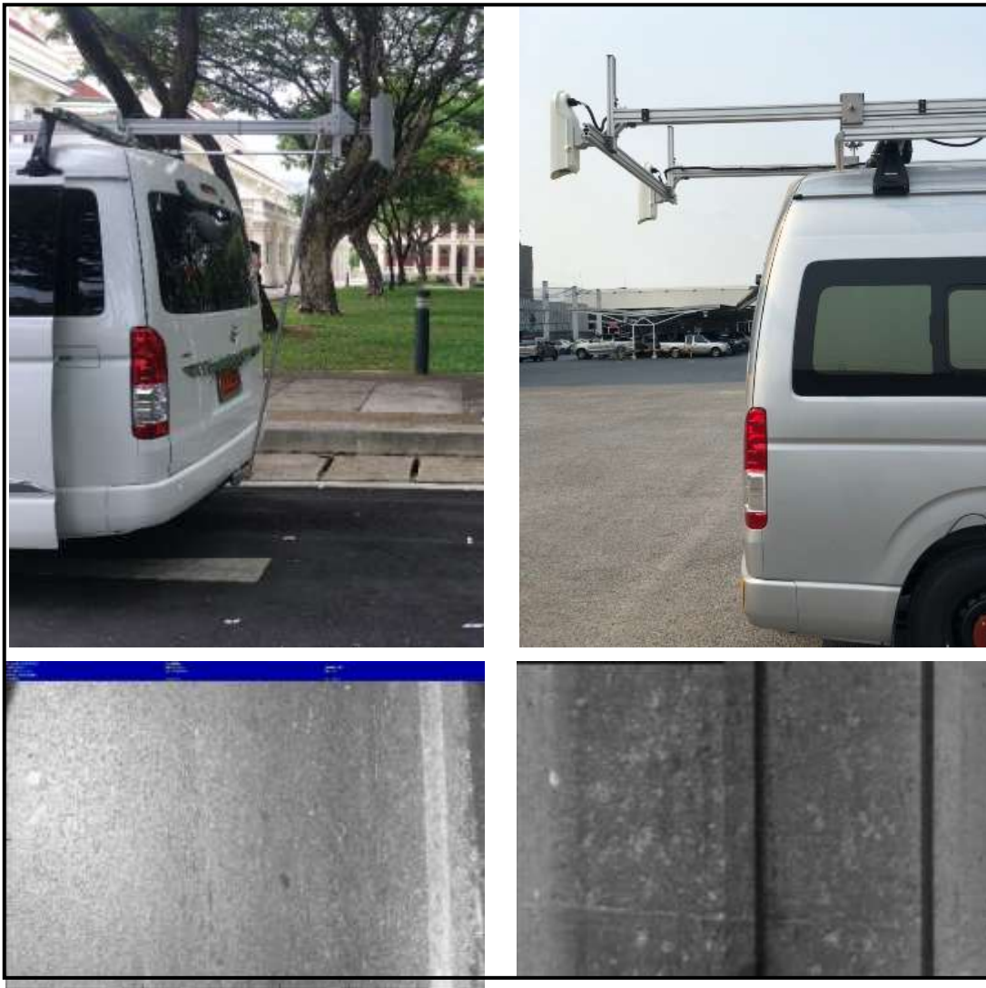
รูปที่ 1-6 กล้องบันทึกภาพผิวทาง และตัวอย่างภาพจากกล้องบันทึกภาพผิวทาง
