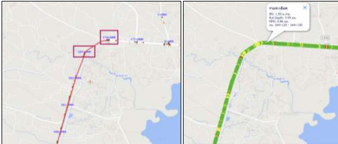
รูปที่ 1-133 หลักกิโลเมตรแสดงผลบนระบบ Roadnet3 ไม่ตรงกับกิโลเมตรข้อมูลสำรวจ สายทาง 22 ตอน 401 สูงเนิน-ท่าแร่ แขวงทางหลวงสกนครที่ 1
