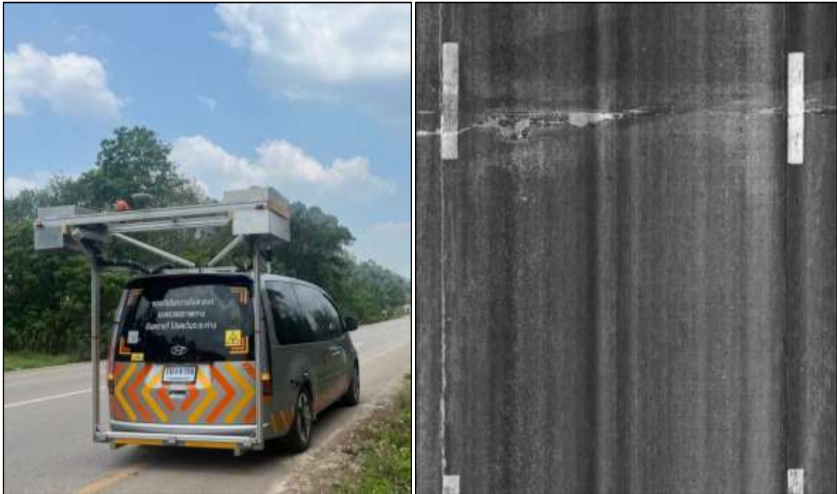
รูปที่ 1-5 อุปกรณ์ถ่ายภาพผิวทาง (LCMS) และตัวอย่างภาพจากอุปกรณ์ถ่ายภาพผิวทาง (LCMS) ตารางที่ 1-6 รายละเอียดกล้องบันทึกภาพผิวทาง โดยการใช้อุปกรณ์ LCMS (ที่ปรึกษาจุฬาลงกรณ์มหาวิทยาลัย)
