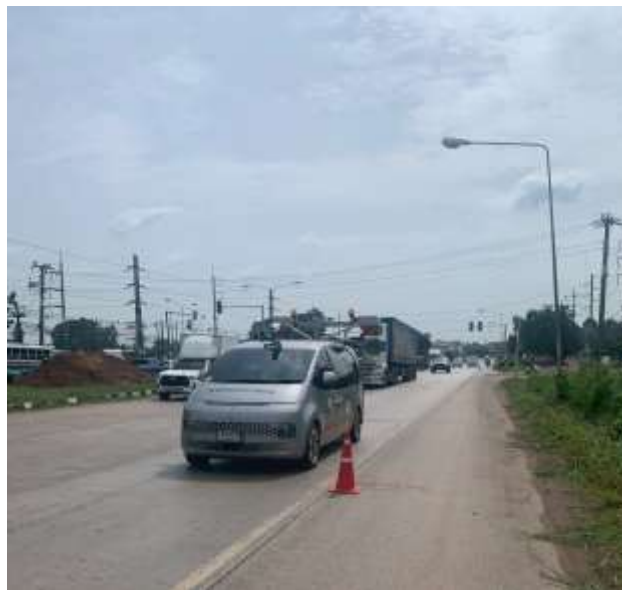
รูปที่ 1-169 รถสำรวจ LCMS สำรวจเมื่อเข้าพื้นที่แปลงทดสอบงานศึกษาที่ 1 ผิวคอนกรีต
