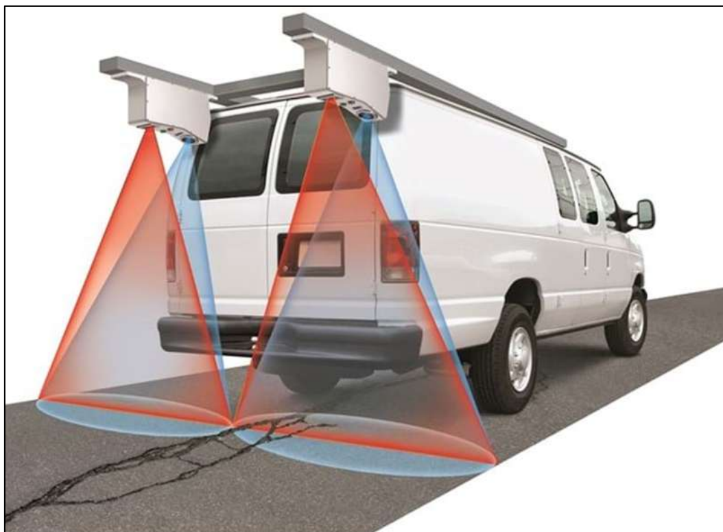
รูปที่ 1-41 แสดงการเก็บข้อมูลด้วยชุดเครื่องมือเลเซอร์ที่ได้จำนวน 4,096 จุด
