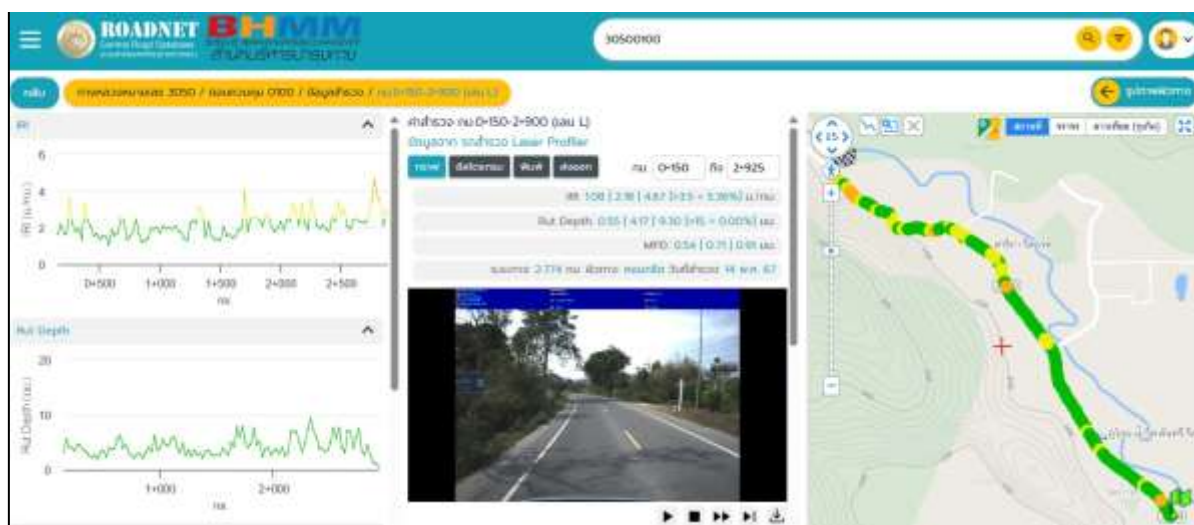
รูปที่ 1-46 แสดงผลการนำเข้าข้อมูลผิวลาดยาง สายทาง 3050 ตอนควบคุม 0100 อุปกรณ์รด์สำรวจ LCMS และรด์สำรวจด้วย Laser Profile
