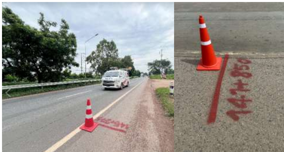
รูปที่ 1-157 เตรียมพื้นที่ศึกษาด้วยการใช้สีสเปรย์และกรวยจราจรสำหรับงานจราจรกำหนด STA เริ่ม-สิ้นสุดการทดสอบ
