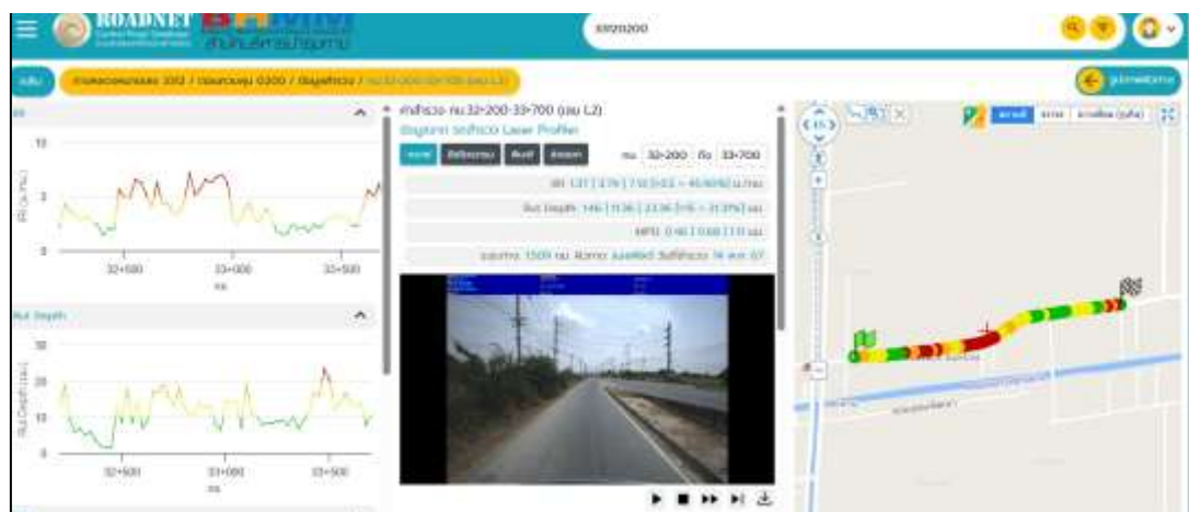
รูปที่ 1-45 แสดงผลการนำเข้าข้อมูลผิวลาดยาง สายทาง 3312 ตอนควบคุม 0200 อุปกรณ์รดสำรวจ LCMS และรดสำรวจด้วย Laser Profile
